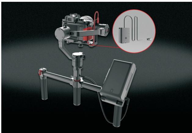
Las 3 baterías 26350 instaladas en el manillar del MOZA AirCross tienen una capacidad de 2000mAh, asegurándose de que aguanten todo el día (hasta 12 horas). Pueden administrar energía a todas las cámaras Sony y Panasonic sin espejos a través de la conexión por puerto DC. Un puerto V en el manillar ofrece además la posibilidad de enganchar una batería externa. Tanto el gimbal como la cámara pueden ser recargados mientras se graba con ellos.
