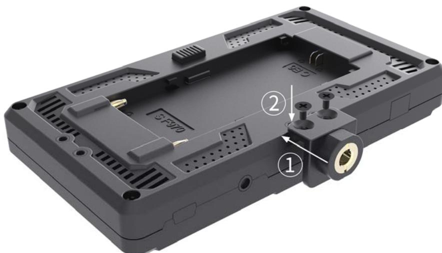
① Asegure el adaptador de tornillo 1/4 al monitor.
