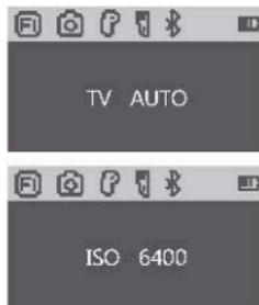
Cuando ajuste los parámetros de la cámara, presione el botón correspondiente y en la pantalla aparecerá el valor, entonces gire el dial para ajustar el valor. Después de finalizar el ajuste, presione el botón correspondiente para apagar los parámetros de ajuste de la cámara.
