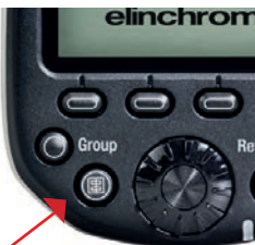
Tecla de test del flash (clic simple = clic derecho, doble clic = clic izquierdo desde Neo 2)
