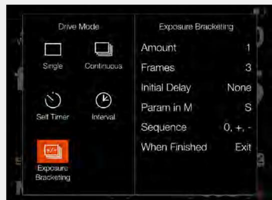
Para el **Temporizador automático**, el **Intervalo** y la **Exposición en horquillado** la parte izquierda del panel muestra la configuración actual. Si no se requieren cambios, toque nuevamente el icono de función para activarlo. Para cambiar cualquiera de los parámetros, toque la parte derecha de la pantalla (A). Esto mostrará los ajustes asignados a la función.
