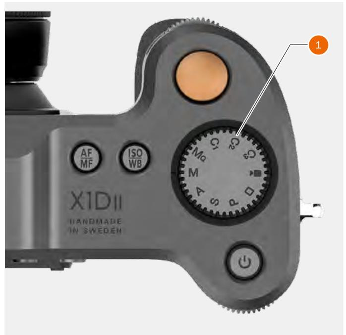
En modo manual, la apertura se fija con la rueda de desplazamiento delantera y, la velocidad de obturación, con la rueda de desplazamiento trasera.
