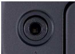
Para disparar el flash desde la cámara (operando con cable), conecte un cable PC Sync desde el puerto PC Sync de la cámara al conector mono de 3,5 mm del NEO 2. (Si la cámara no dispone de puerto PC Sync, puede comprar el adaptador opcional de zapata de accesorios a PC de Rotolight y el cable de sincronización de flash PC, que convierte la zapata de accesorios en una toma PC).
